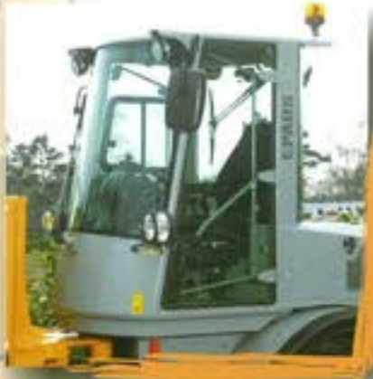
Beidseitiger, ebener Einstieg, Steuerkonsole nach hinten klappbar, ergonomisch geformter Joystick, orthopädischer Komfortsitz mit Sicherheitsgurt und Bandscheibenstütze
