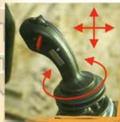
Elektrohydraulische Vorsteuerung über Multifunktions-Joystick. Schwenkfunktion über Drehen des Joysticks
