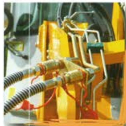
Zusatzanschluß für hydraulische Anbaugeräte z.B. Betonmischschaufel o. Kehrmaschine
